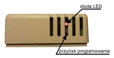
Dioda LED – LED Przycisk programowania – Program setting switch
